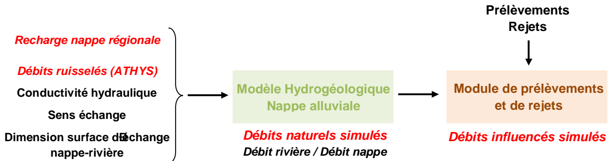
Illustration n° 10: Synoptique du modèle hydrogéologique des échanges nappes-rivières
